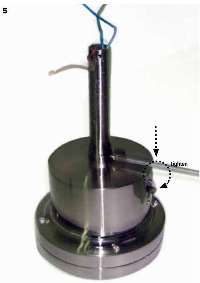
cómo montar el ventilador - com muntar el ventilador - how to install the fan -comment monter le ventilateur - come montare il ventilatore - montar o ventilador - montage des ventilators - installatie van ventilator - οδηγίες τοποθετησης του ανεμιστηρα - установка вентилятора - návod k závesné montáži ventilátora - sposób instalacji wentylatora - монтиране на вентилатора - montáž ventilátora
